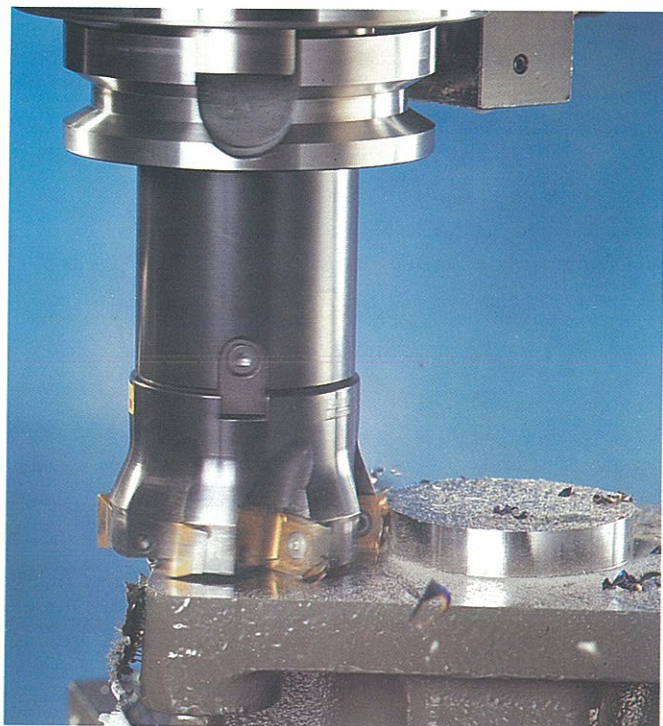
Sandvik Coromants nya fräs T-Max 290 har egenskaper som gör den idealisk för verkstäder som arbetar med korta serier och därmed har behov av att minska omriggningstiden.
