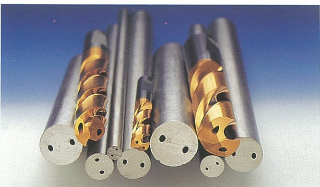
Vid företagets anläggningar i Coventry, England, görs homogena hårdmetallstavar för spiralborrar. Borrämnen, som har dubbla kylkanaler, utsätts för mycket noggrann tillverkningskontroll.
