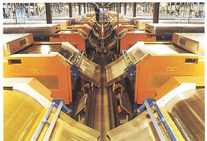
Hos Shell i Canada finns 46 Rotoform-system i världens största anläggning för att omvandla svavel till lätthanterliga pastiller.
